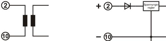
Abb. 1: links: AC-Anschluss; rechts: DC-Anschluss
