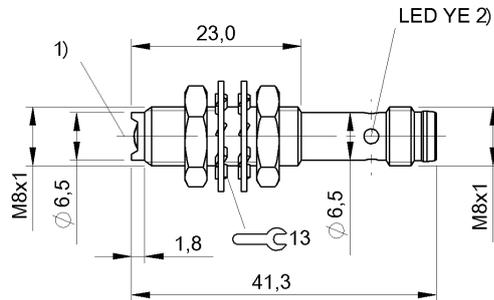
1) Optische Achse, 2) Ausgangsfunktion
