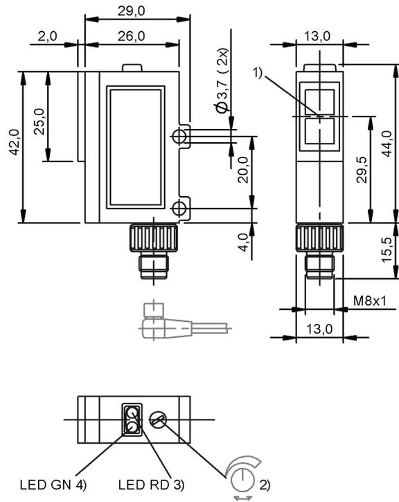
1) Optische Achse, 2) Sn, 3) Ausgangsfunktion, 4) Stabilität
