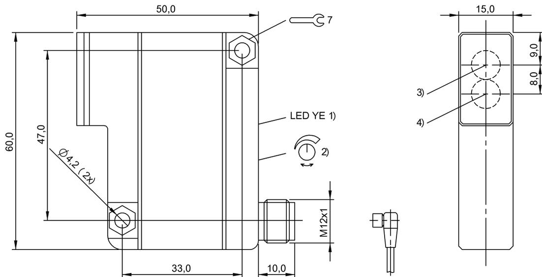
1) Ausgangsfunktion, 2) Sn, 3) Optische Achse Sender, 4) Optische Achse Empfänger
