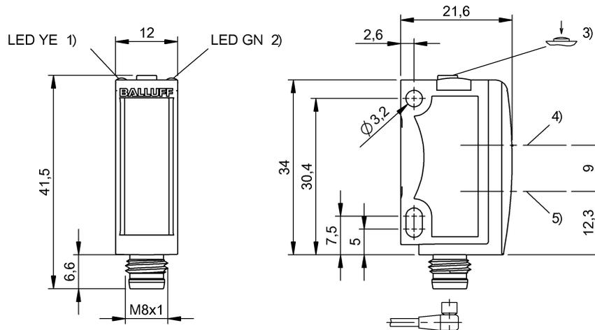
1) Ausgangsfunktion, 2) Betriebsspannung, 3) Sn, Hell/Dunkel, 4) Optische Achse Empfänger, 5) Optische Achse Sender
