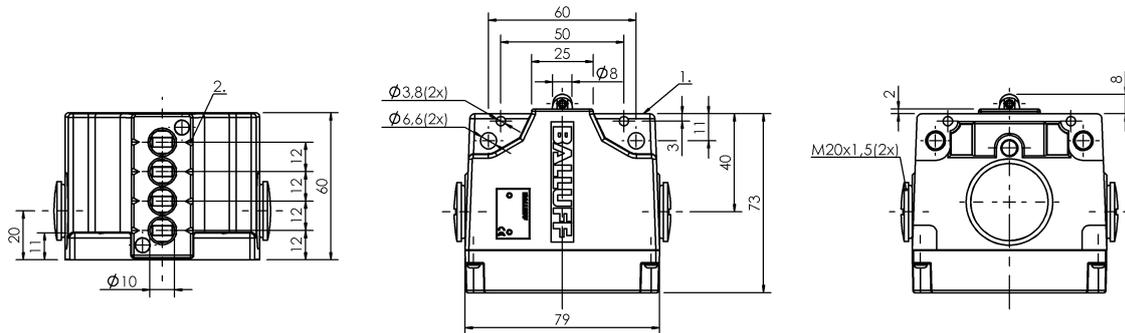
1) Bezugskante, 2) Mark. Sicherh. Schaltstelle
