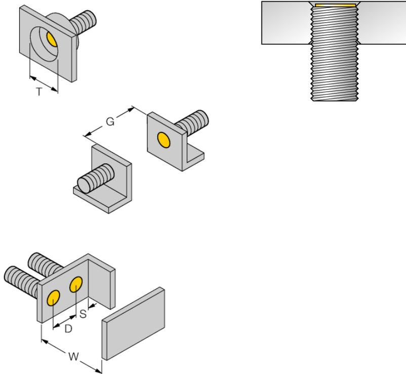
Bei allen bündigen *uprox*®+ Gewinderohrschaltern ist ein überbündiger Einbau erlaubt. Bei einem zurückgesetzten Einbau von einer halben Gewindeumdrehung ist ein sicherer Betrieb gewährleistet.
